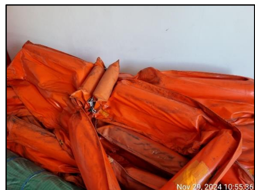
รูปที่ 17 Boom ดักน้ำมัน
